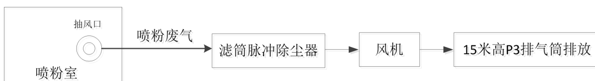
图 3.1-7 喷粉废气收集处理气路连接处理示意图
