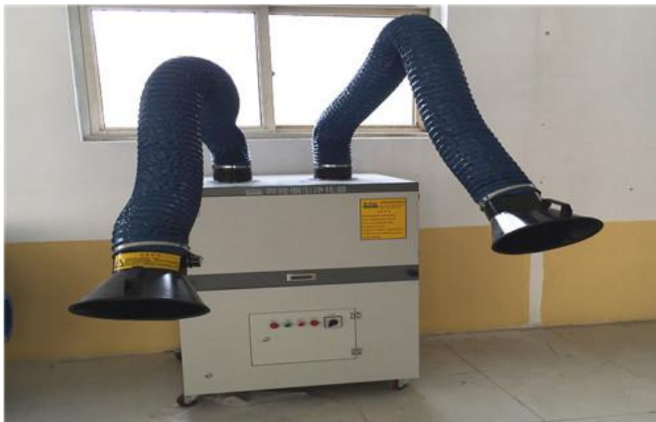
图 7-8 移动式焊接烟尘除尘装置示意图
