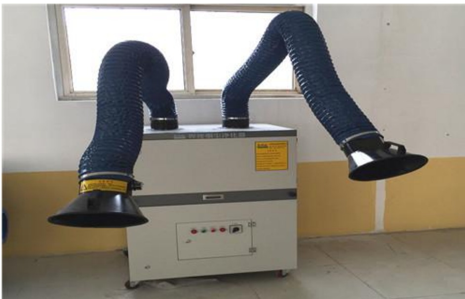
图 7-8 移动式焊接烟尘除尘装置示意图
