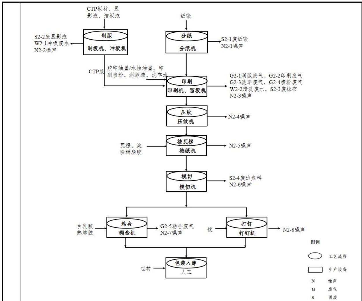
图 2-2 扩建后纸箱生产工艺及产污环节点
