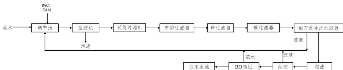
图 4-1 冷却循环弃水处理装置处理工艺流程图
