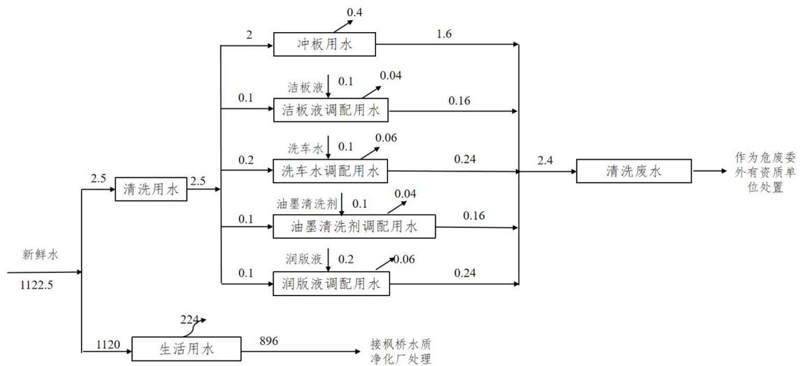
图 5-1 扩建前全厂水平衡图 (m<sup>3</sup>/a)
