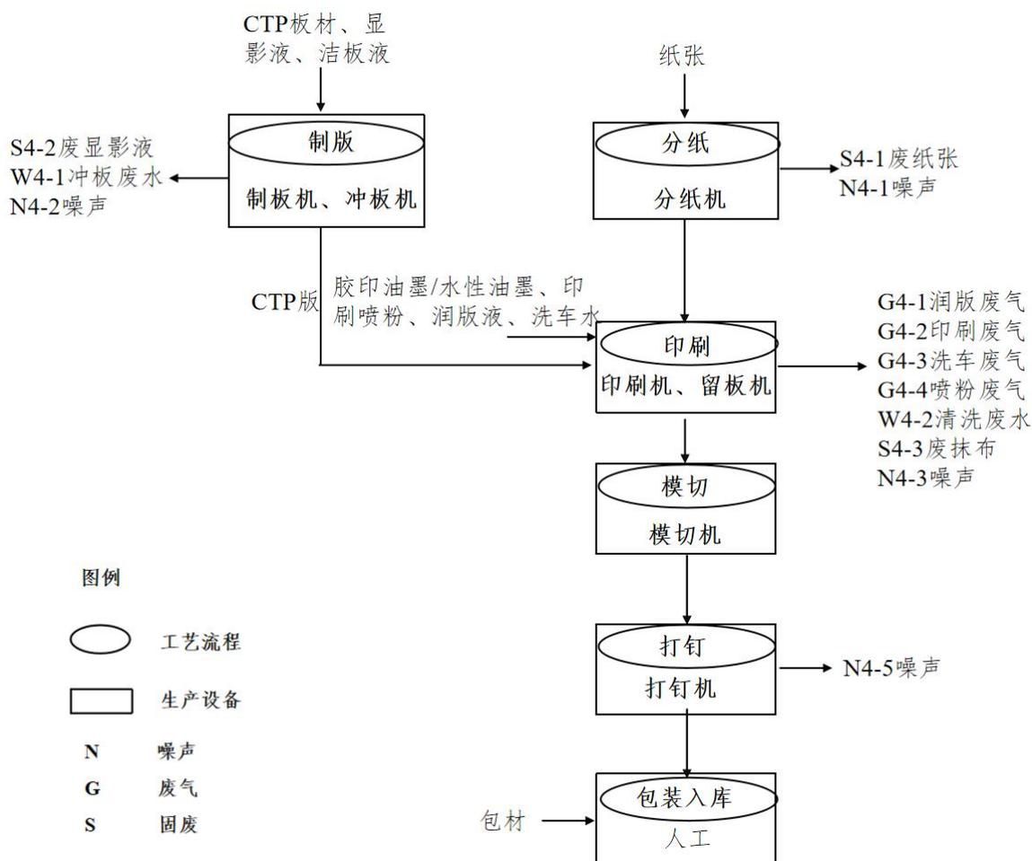
图 2-4 扩建后印刷品生产工艺及产污环节点
