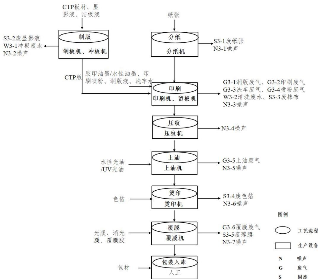
图 2-3 扩建后纸卡生产工艺及产污环节点
