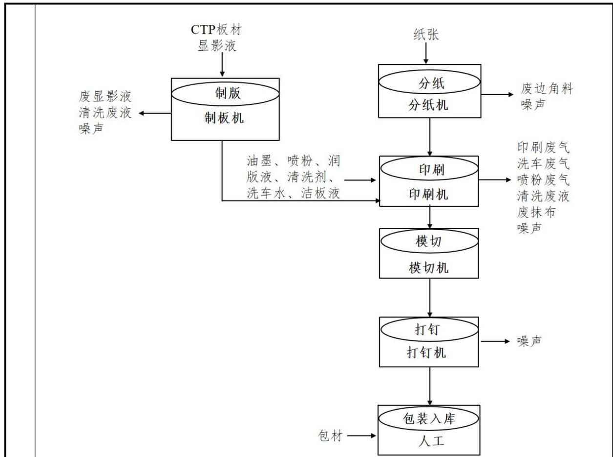
图 2-5 印刷品生产工艺流程图
