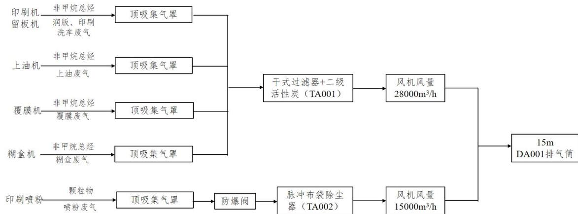
图 4-2 废气处理系统示意图
