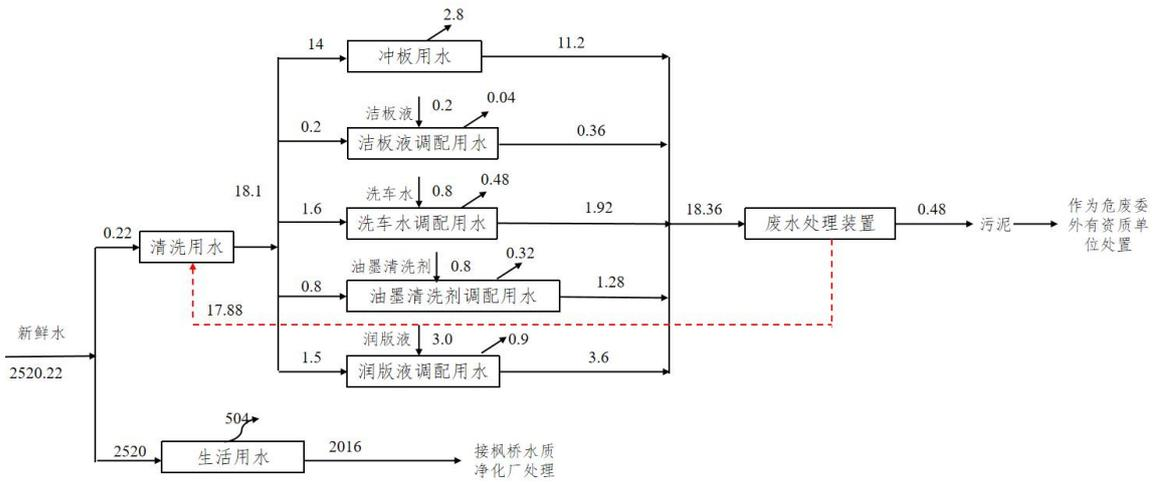
图 5-2 扩建后全厂水平衡图 (m³/a)
