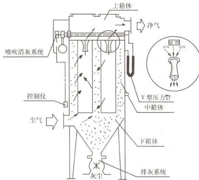
图 4-3 脉冲袋式除尘器工艺原理图
