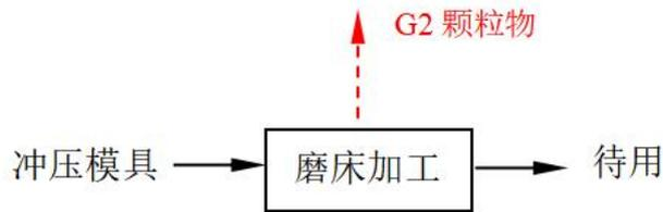
图 2-5 冲压件模具维修工艺流程图
