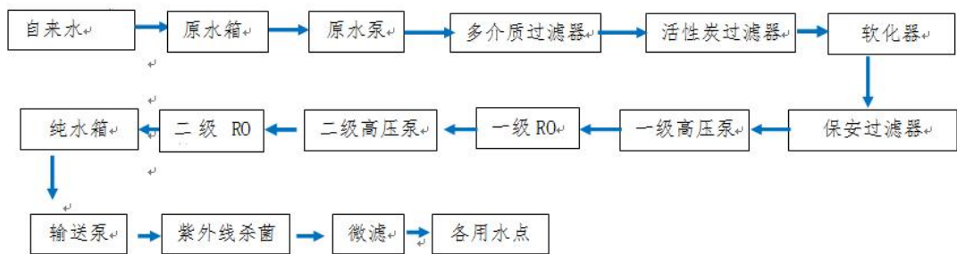
图 2-2 纯化水制备系统工艺流程图
