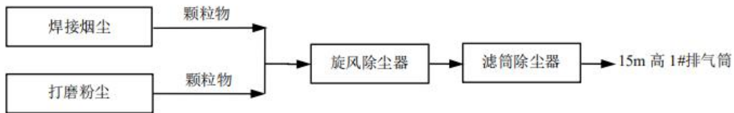
图 7-1 焊接、打磨废气治理流程图
