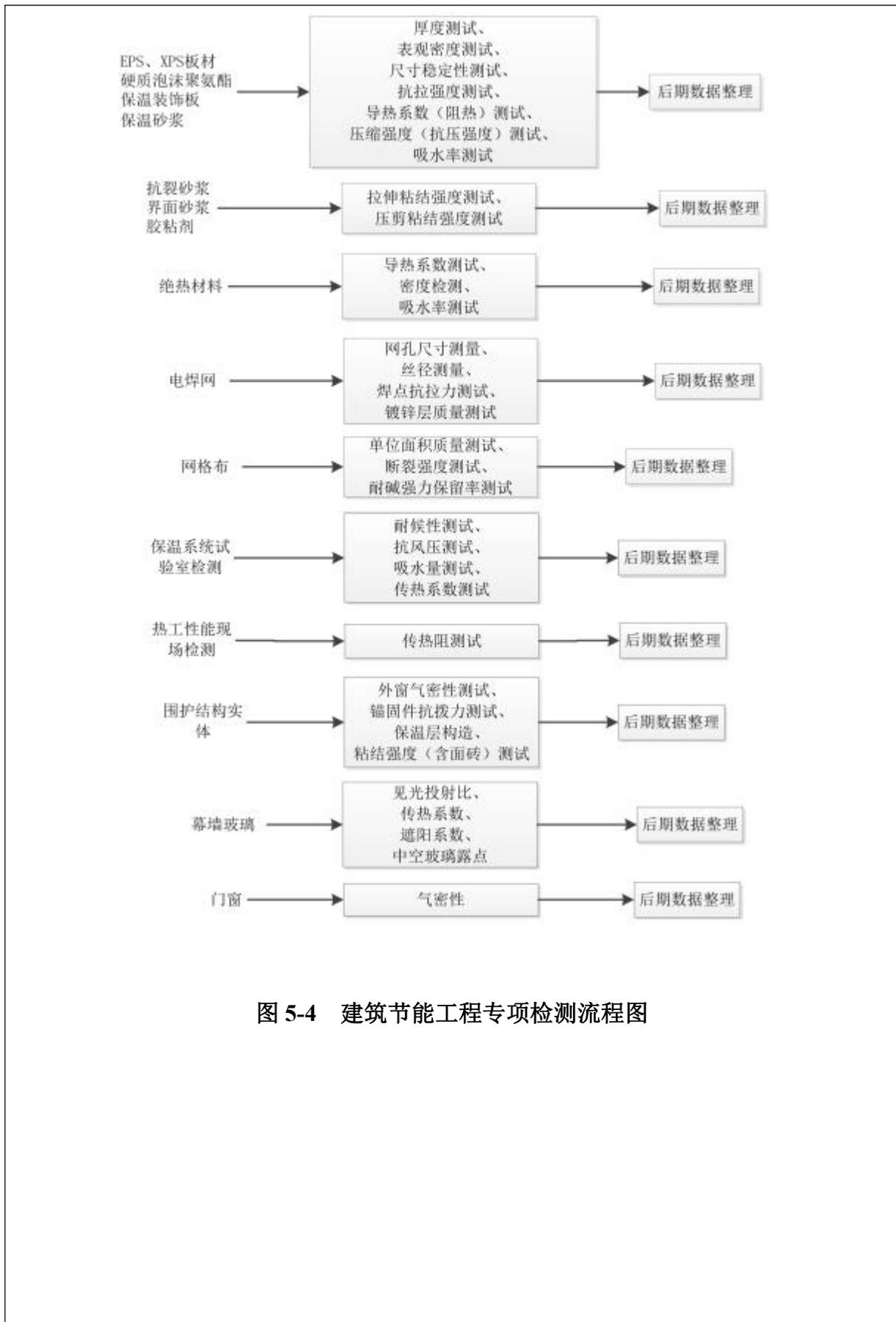
图 5-4 建筑节能工程专项检测流程图
