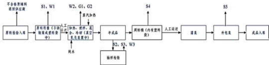
图 5-2 液态化妆品工艺流程
