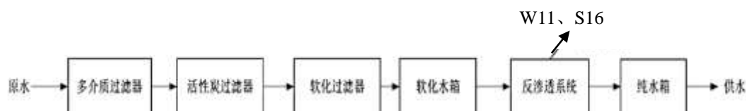
图5-5 纯水制备工艺流程
