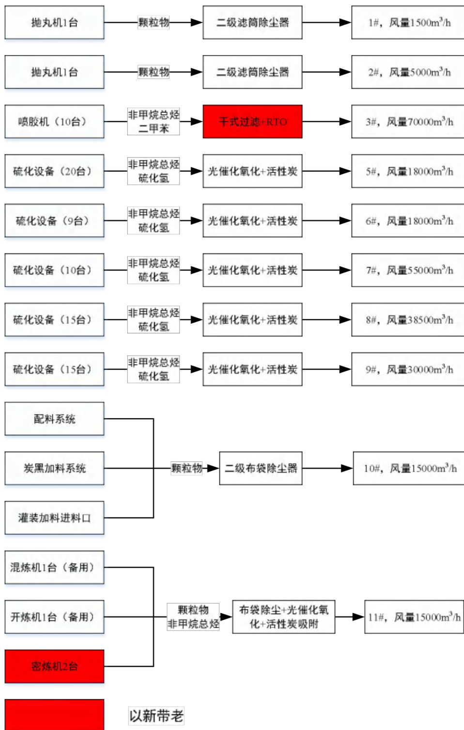
图 3.7-1 现有项目采取以新带老措施后废气处理工艺流程图
