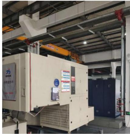
3T 数字式电动振动试验系统+三综合试验箱 (1m³)
