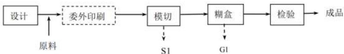
图 3-1 生产工艺流程及产污环节图
