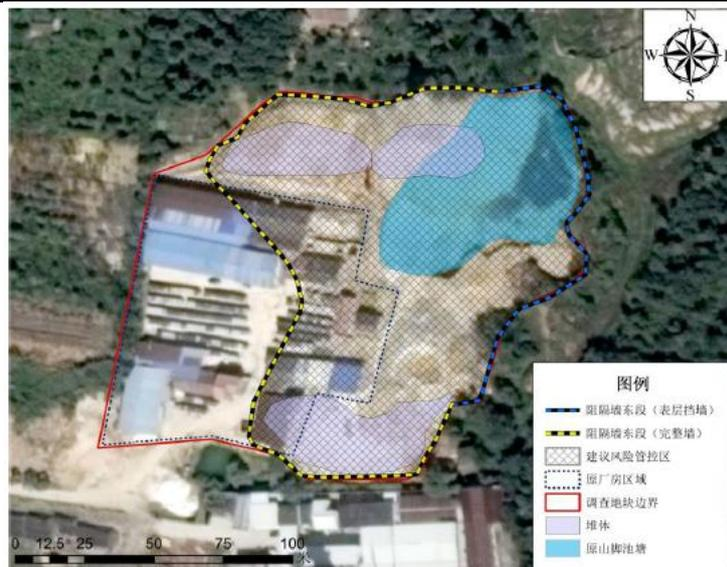
图 5-4 混凝土垂向防渗阻隔墙分段建设范围示意图
