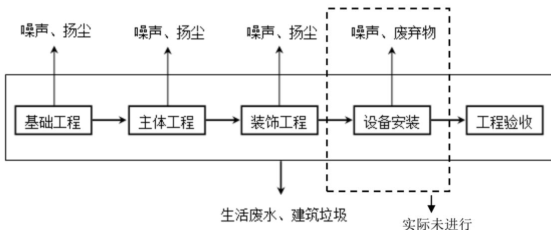
图 5-1 施工流程及主要污染情况简图（虚线内为原有设计环节，实际未进行建设）
