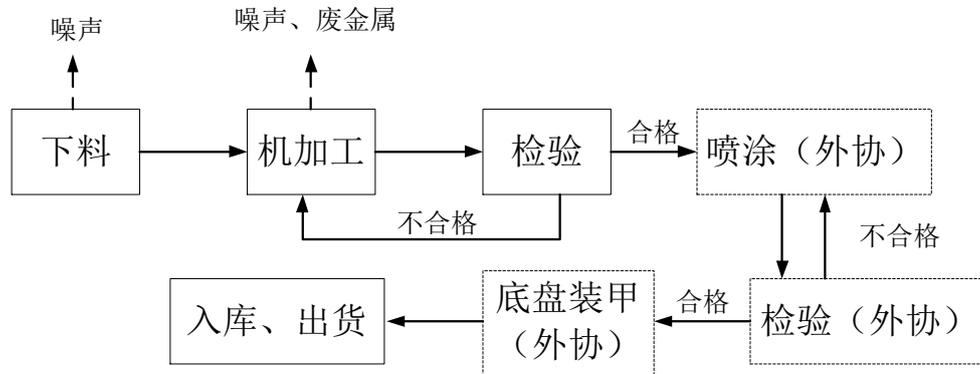
图 5-1 项目生产工艺流程及产污节点图
