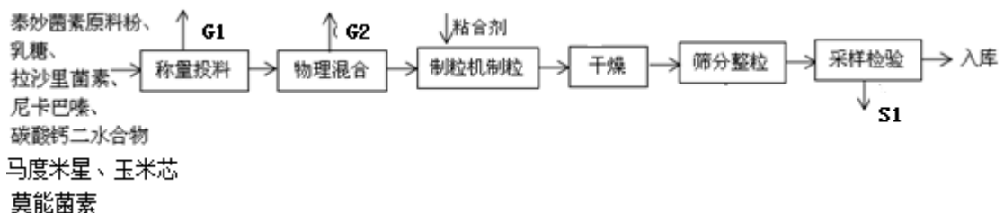
图 1.5 颗粒预混剂生产工艺流程图
