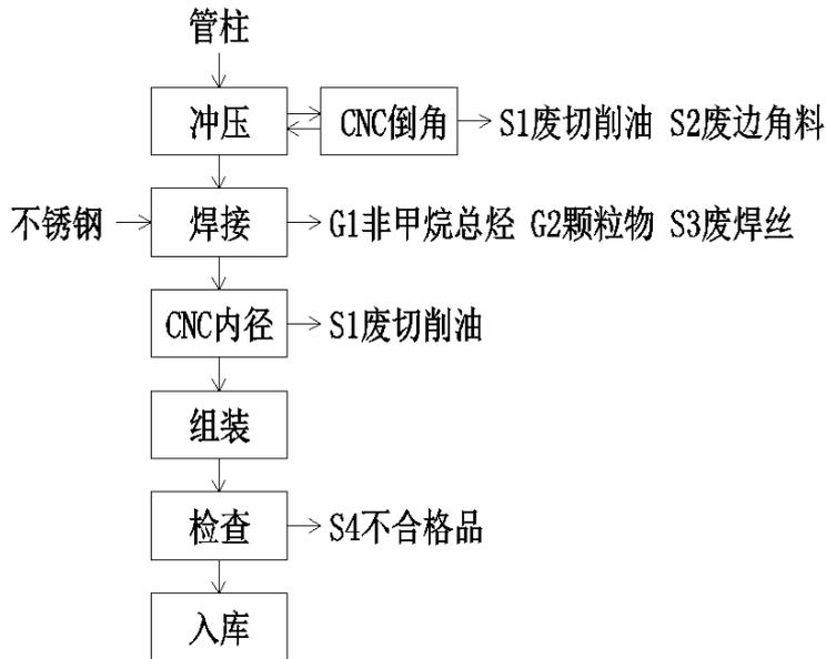
图 3.5-1 项目生产工艺流程图
