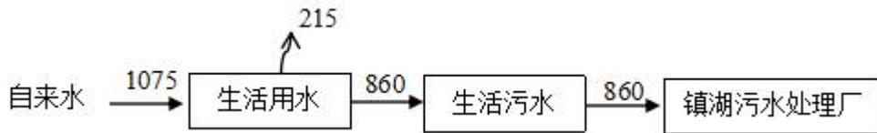
**图 5-5 扩建后全厂水平衡图 (t/a)**
