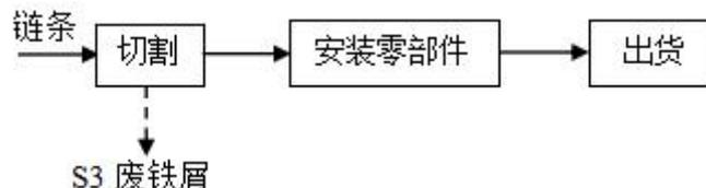
图 5-4 链条生产工艺流程图
