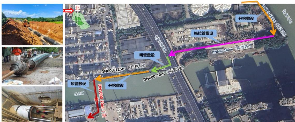
图 4-1 污水厂出水输送管路由图
