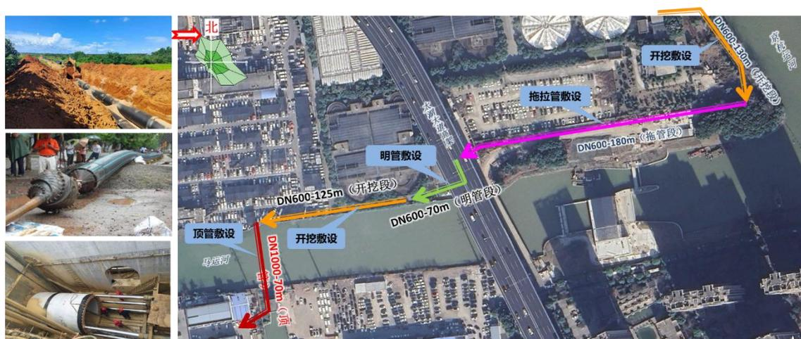
图 3.5-1 污水厂出水输送管路由图
