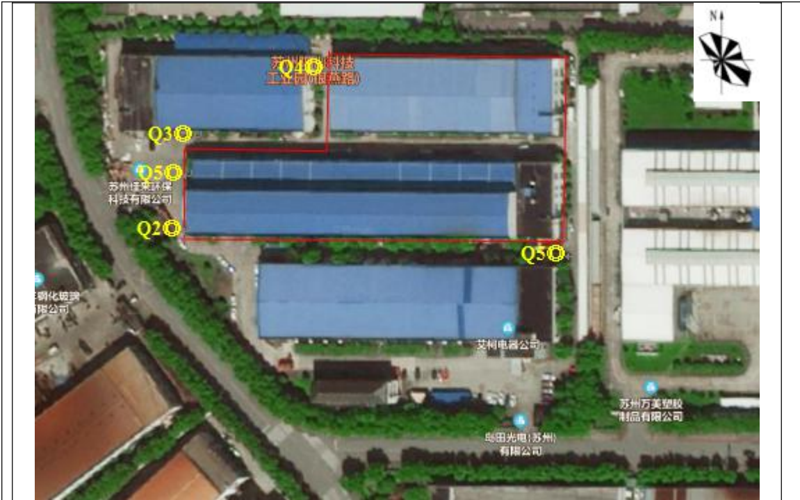
2020年5月21日废气无组织监测点位示意图(注:⊙代表无组织监测点位)
